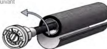
3.- Réinsérer le mécanisme dans le tube
