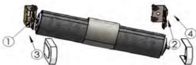
Insérer la store dans les supports en commençant par l'axe fixe (le côté opposé du mécanisme) et ensuite le côté du mécanisme. La roue dentelée permet de libérer l'axe pour démonter le store. Ensuite, fixer les caches des supports
