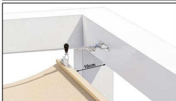
Nous réduirons la toile de 10cm sur l'avancée pour la fixation du système de tension des câbles.
